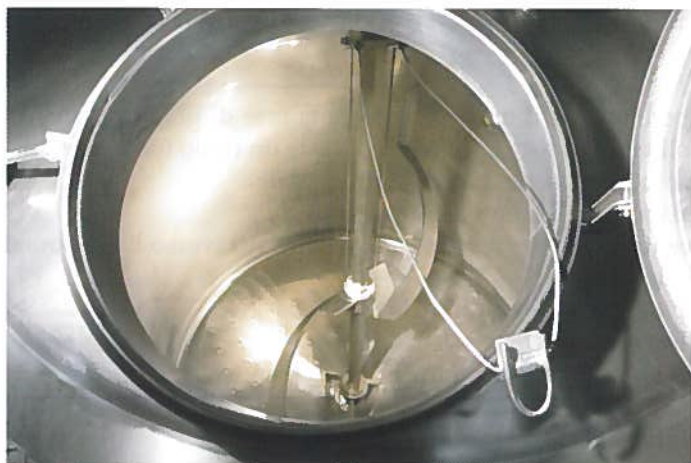
Fig. 12.19 - Serbatoio Whirlpool (Impiantinox Srl).
