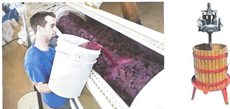
Fig. 11.10 - Torchio industriale (a sinistra) e torchio artigianale (a destra) utilizzati per le operazioni di torchiatura vinaria.
