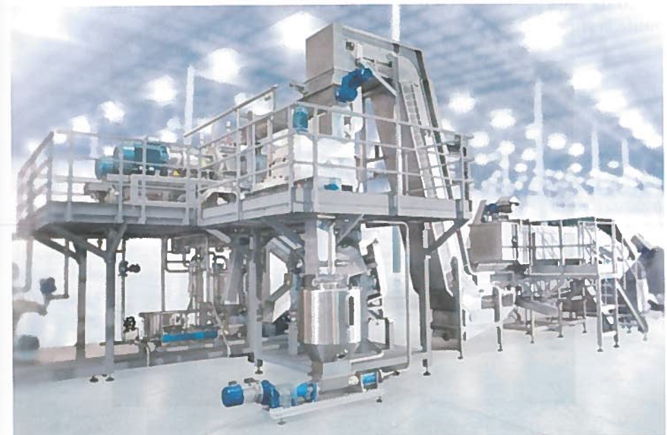
Fig. 7.19 - Impianto completo di inattivazione enzimatica per frutta e vegetali "Zenith Chrono" (CFT S.p.A).
