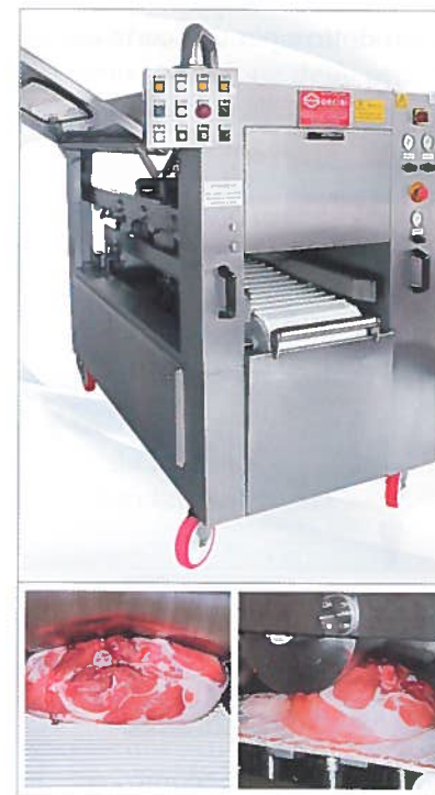
Fig 15.1 - Massaggiatrice/Spremitrice (Macchine Soncini Alberto Srl).
