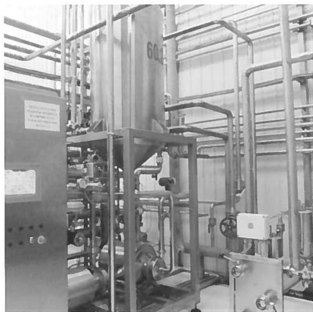
Fig. 7.31 - Sistema di degasatura a vuoto (ADUE S.p.A).
