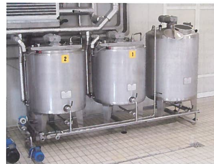
Fig. 13.36 - Fermentiere (Progema Engineering S.r.l.).
