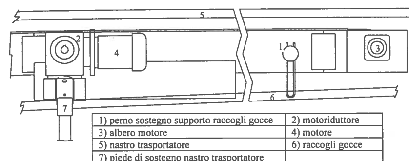
Fig. 9.6 - Componenti principali del bancale di trasporto bottiglie con nastri trasportatori table-top o flex-top.
