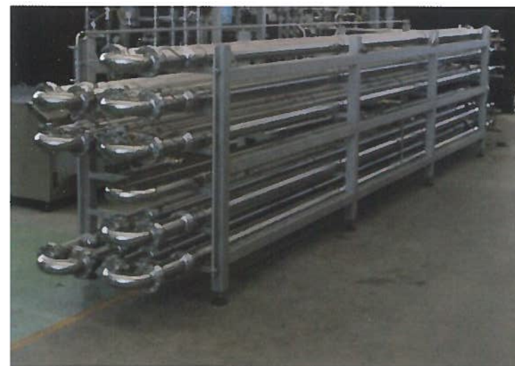
Fig. 7.30 - Sistema di sterilizzazione bevande base frutta con scambiatori tubolari (CFT S.p.A.).
