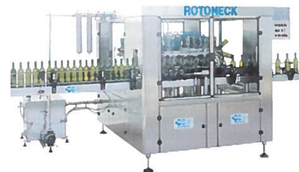
Fig. 6.76 - Sciacquatrice con presa per il collo (Promec Srl).
