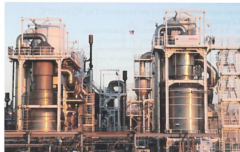
Fig. 14.13 - Evaporatore D.F.F. Venus (CFT Spa).
