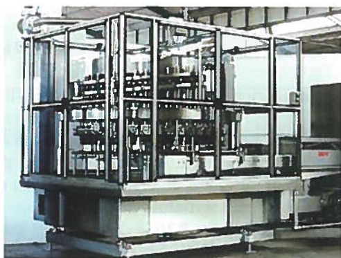
Fig. 8.11 - Riempitrice volumetrica a giostra con pistoni (Zanichelli Meccanica SpA).
