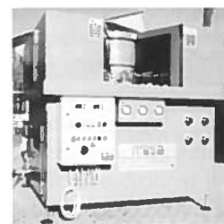
Fig. 6.7 - Macchina lavatrice rotativa.
