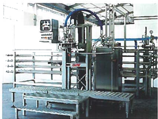
Fig. 14.24 - Riempitrice a singola testa per riempimento in asettico di bag in fusti (Zanichelli Meccanica Spa).
