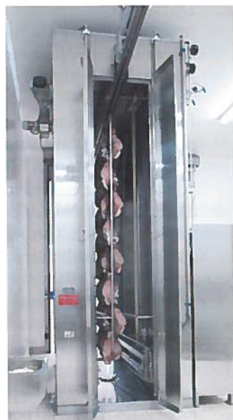
Fig. 15.3 - Cabina per il lavaggio prosciutto crudo (Macchine Soncini Alberto Srl).
