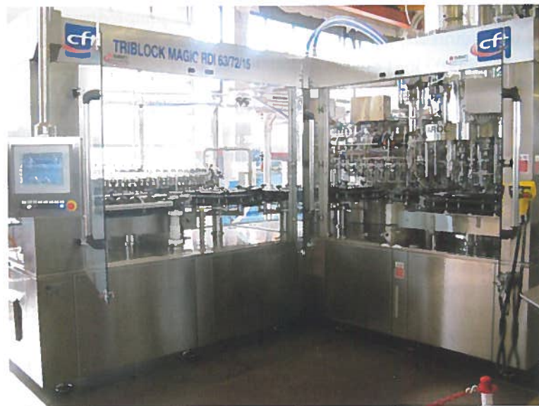
Fig. 11.11 - Riempitrice a depressione inferiore per vino fermo (CFT SpA).
