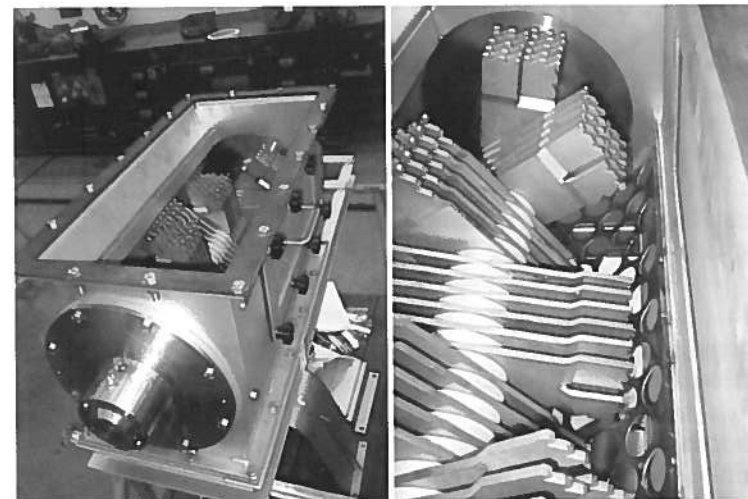
Fig. 7.16 - Mulino a martelli per la triturazione di frutta e vegetali (CFT S.p.A.).
