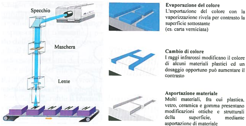
Fig. 8.74 - Sistemi di marcatura e codifica a raggi laser (ALLTEC).
