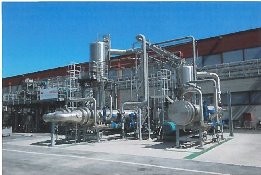
Fig. 14.9 - Inattivatore enzimatico Eldorado (CFT Spa).
