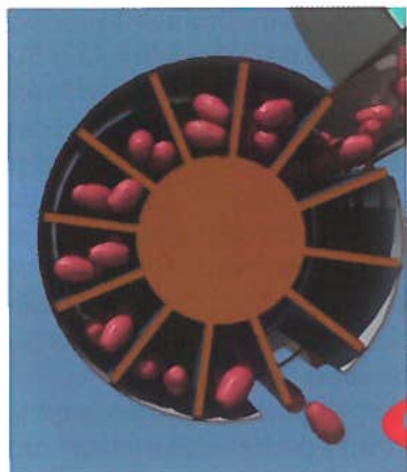
Fig. 7.12 - Valvola di scarico di una pelatrice sottovuoto per vegetali e frutta (CFT S.p.A).
