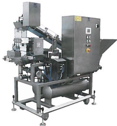
Fig. 17.9 - Dosatore volumetrico sottovuoto per paste e prodotti alimentari non pompabili (Storci Spa).
