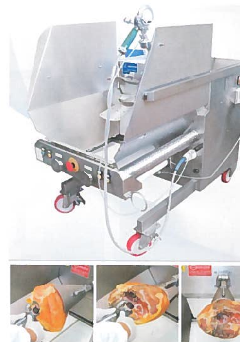
Fig. 15.6 - Coltello pelatore elettrico (Macchine Soncini Alberto Srl).
