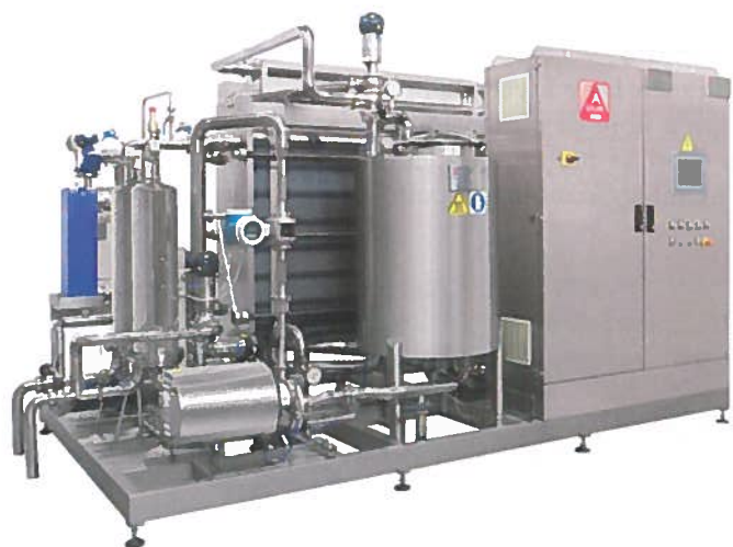
Fig. 7.28 - Impianto per trattamento di pastorizzazione in massa a piastre (ADUE S.p.A).
