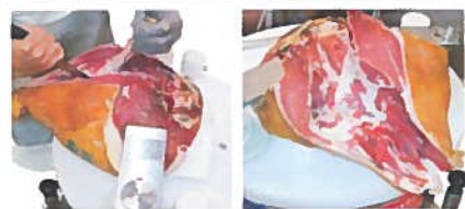
Fig. 15.8 - Disossatrice per aperto (Macchine Soncini Alberto Srl).
