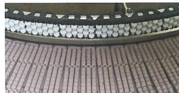
Fig. 9.20d - Nastri a rulli in resine acetaliche.
