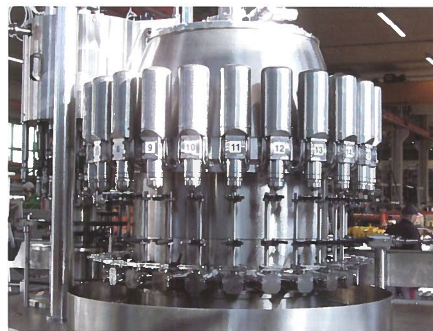
Fig. 8.17 - Sistema di riempimento ponderale a celle di carico per olio (CFT SpA).
